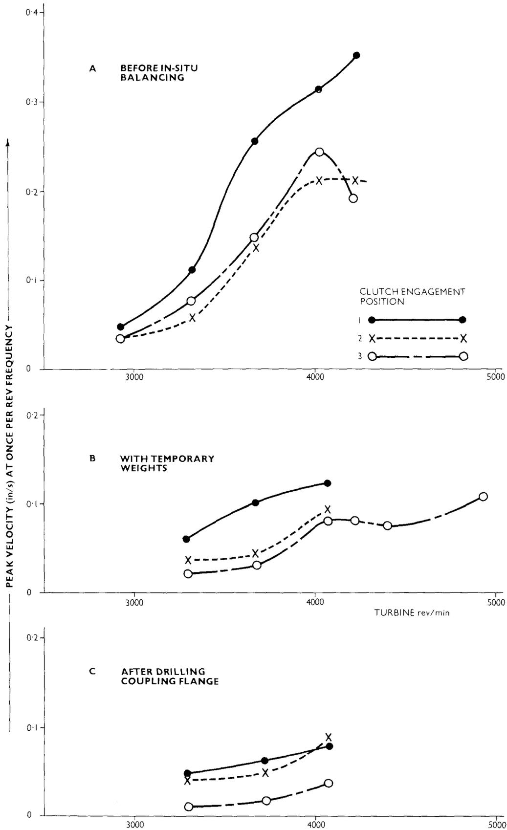
FIG. 2—COSAG STEAM TURBINE INPUT LINE—VIBRATION LEVELS AT COUPLING SUPPORT BEARING
