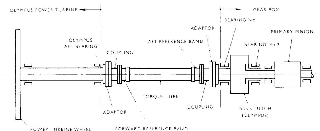
FIG. 5—TYPE 21 FRIGATE/TYPE 42 DESTROYER HIGH-SPEED LINE
