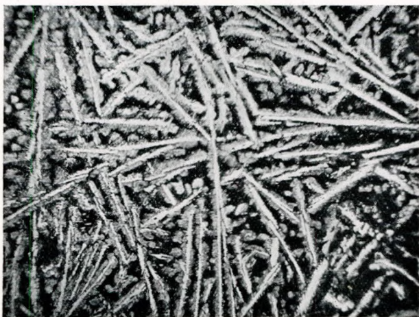
Fig. 1. Copper-tin Alloy. Copper 10 per cent. Tin 90 per cent.
